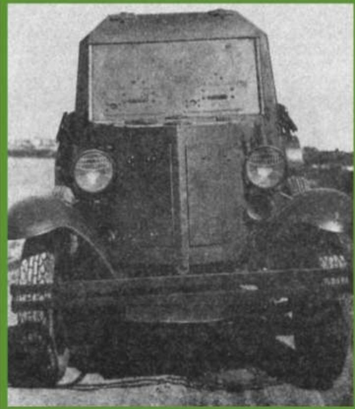
Бронеавтомобили имели несущие корпуса, как правило закрытого типа, с вращающейся башней. Шасси были 2- и 3-осные, в основном полноприводные, с пулеметными башнями, пневматическими шинами. Но в ходе войны стала очевидной уязвимость бронеавтомобилей для артиллерии и ударов авиации, невысокая проходимость, а потому их использование к 1942 году было значительно сокращено.
